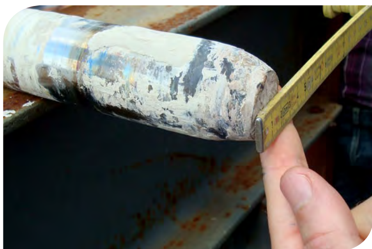
► Arbre de pompe de production endommagé par des dépôts de calcite.
